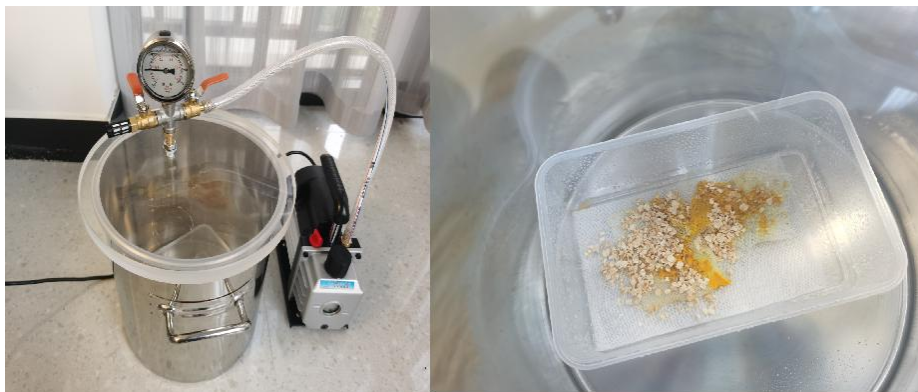
（图 3-3 用自制真空机在负压-0.9Bar 下处理黏菌）
