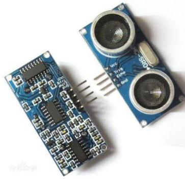
图 27 HC-SR04 超声波测距模块
