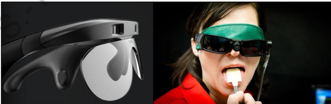
图3 美国 Wicab 盲人助视产品（摄像头获取影像，利用舌头上的电极在大脑中重建影像，价格 1 万美元上下，约 64660 元）
