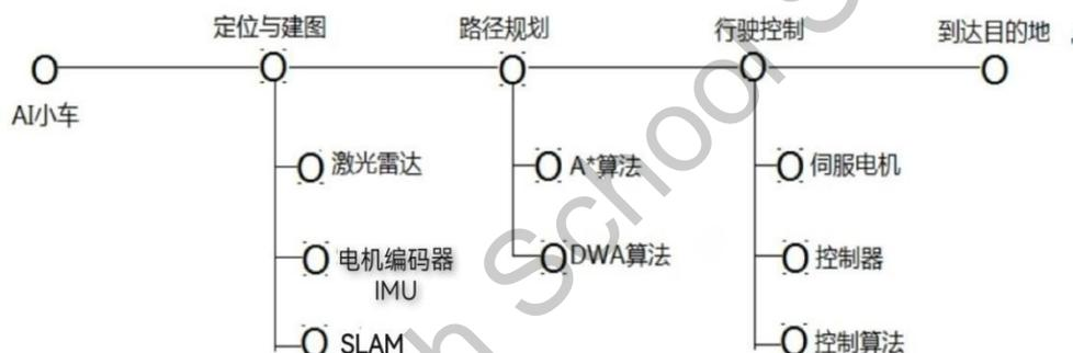
图 12 无障碍物时小车导航原理
