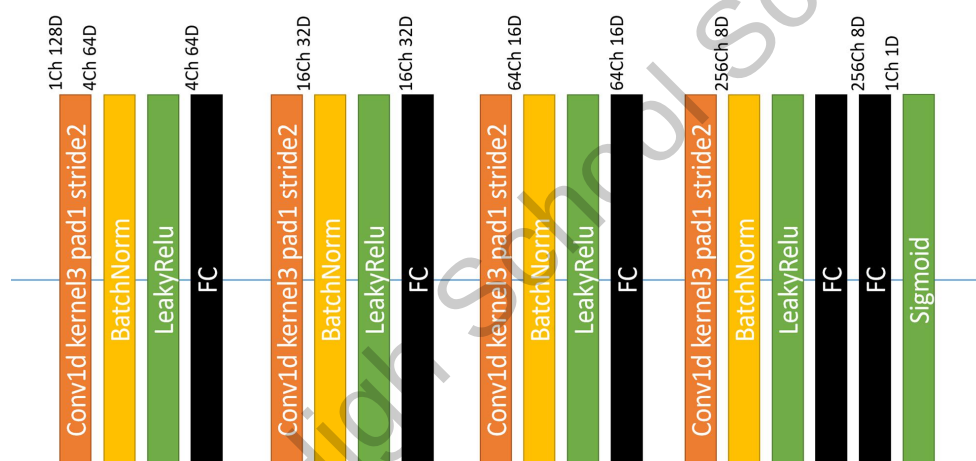
图4 SRGAN判别器网络结构图
