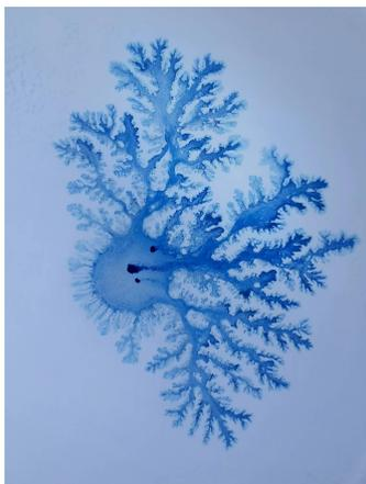
图 2.2: 当丙烯基底不均匀、台面不平整时分形手指的整体形态
