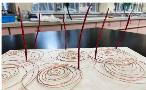
Fig. 2.26 'Plastic wrapped' electrode
