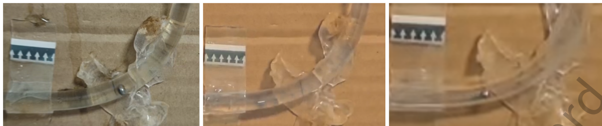
图 25 有阻尼实验轨道设置：轨道参数均为 n = 3, C = 200 \text{ m}^{-2} ；左图管内为蜂蜜水，测得系数 \tilde{\mu} = 64.4 ；中图管内为水，测得系数 \tilde{\mu} = 15.3 ，右图管内无填充，即 \tilde{\mu} = 0
