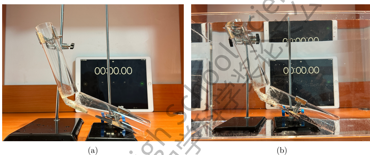
图 6 离散轨道实验装置. (a) 无阻尼离散轨道实验装置 (b) 有阻尼离散轨道实验装置
