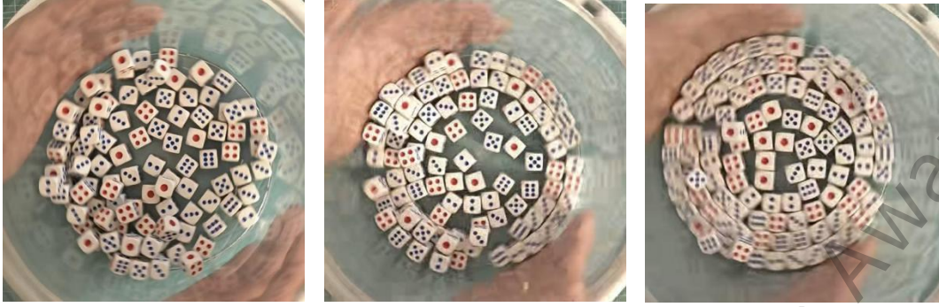
图21：单层骰子实验过程俯视图，可以看出随着转动次数的增加，骰子变得有序
