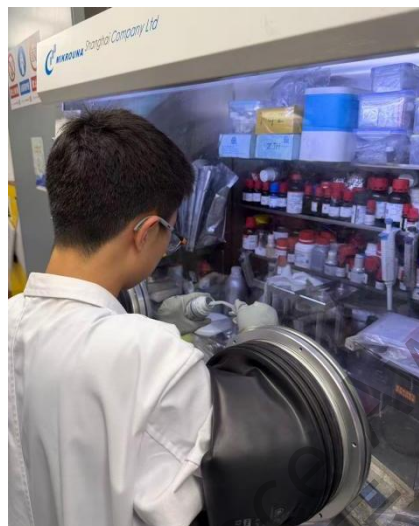
图 S4 手套箱内拿取盐调配电解液
