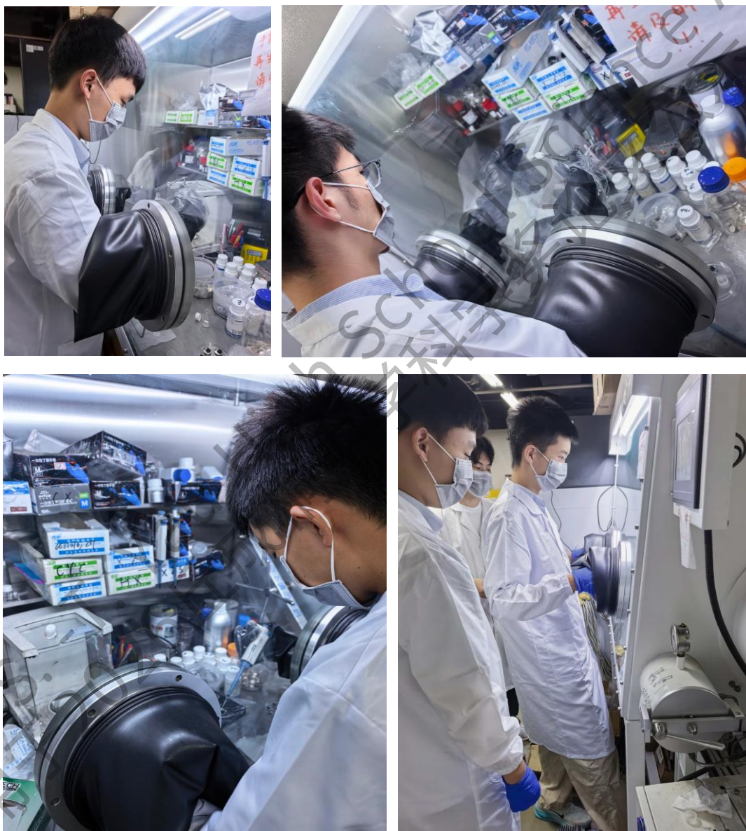
图 2.8 小组成员在实验室手套箱内进行电极制备及电池组装。
