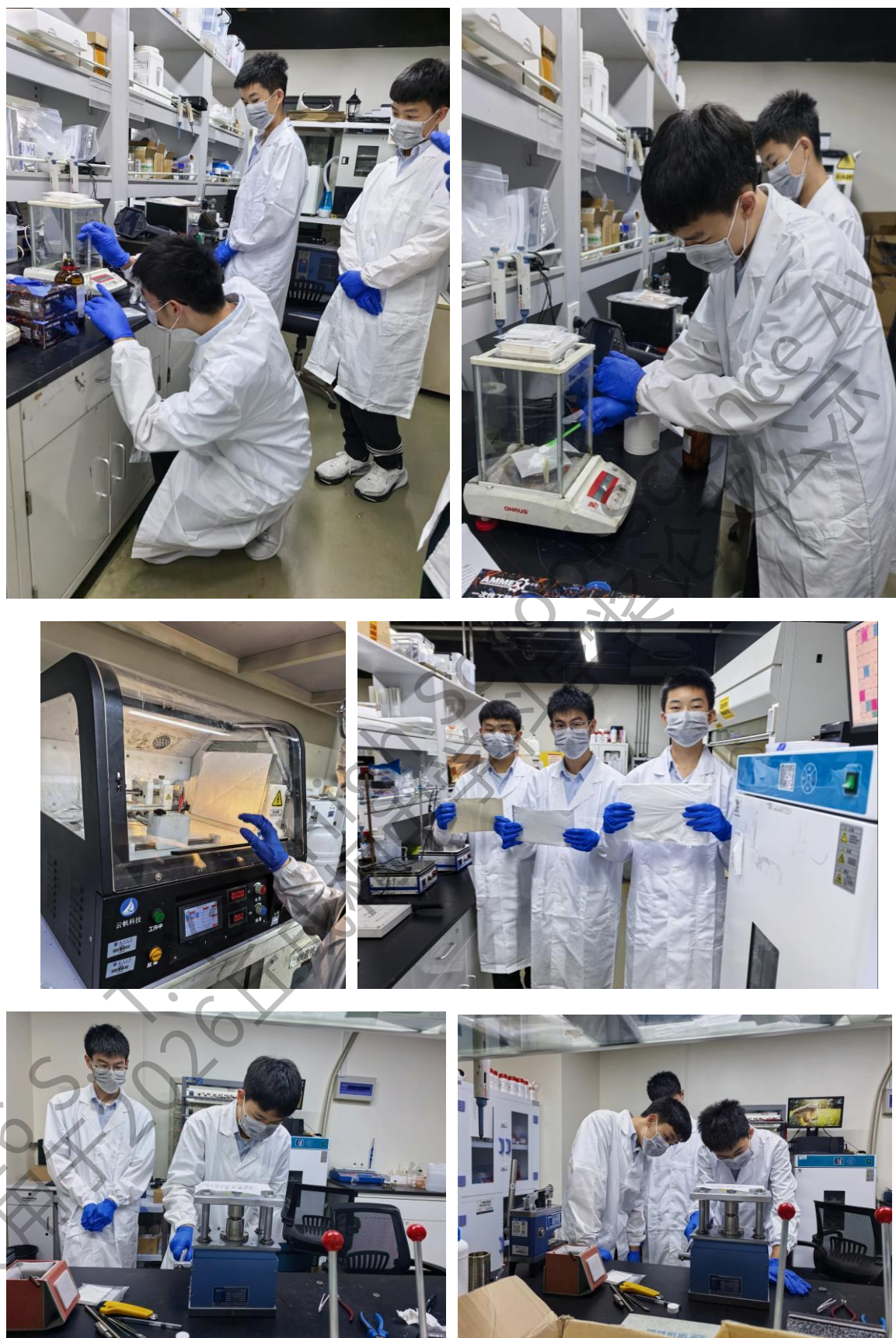
图 2.1 小组成员在实验室进行 HE-ZIF@PAN 复合固态电解质制备及电池组装实验。
